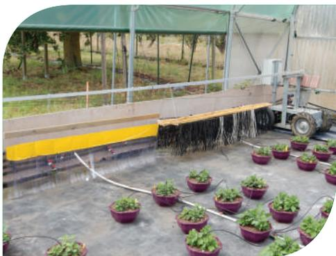
Figure 4 : Système de stimulation mécanique équipé de deux lignes de tuyaux de goutteur.
