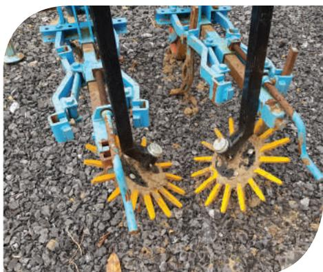
Figure 2 : Bineuse à doigts.
