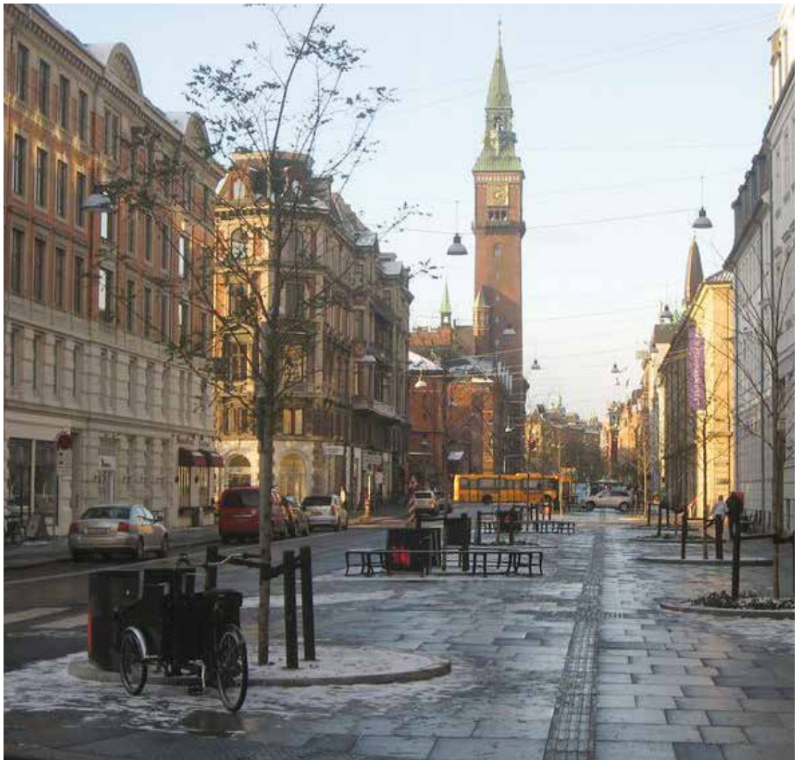
Durant les mois d'hiver, des protections en plastique noir d'un mètre de haut sont placées côté circulation autour des arbres dans les rues principales de Copenhague pour prévenir les arbres du sel. Image : Anne Jaluzot
