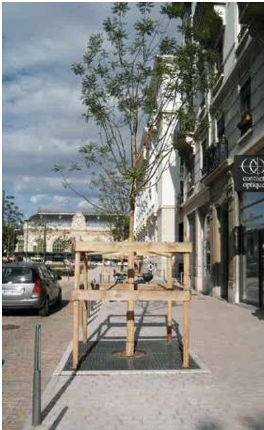
Images non créditées : Anne Jaluzot Natte de bambou et tuteurage quadripode à Lyon, là où une protection temporaire plus importante est requise. Image : Sue James
