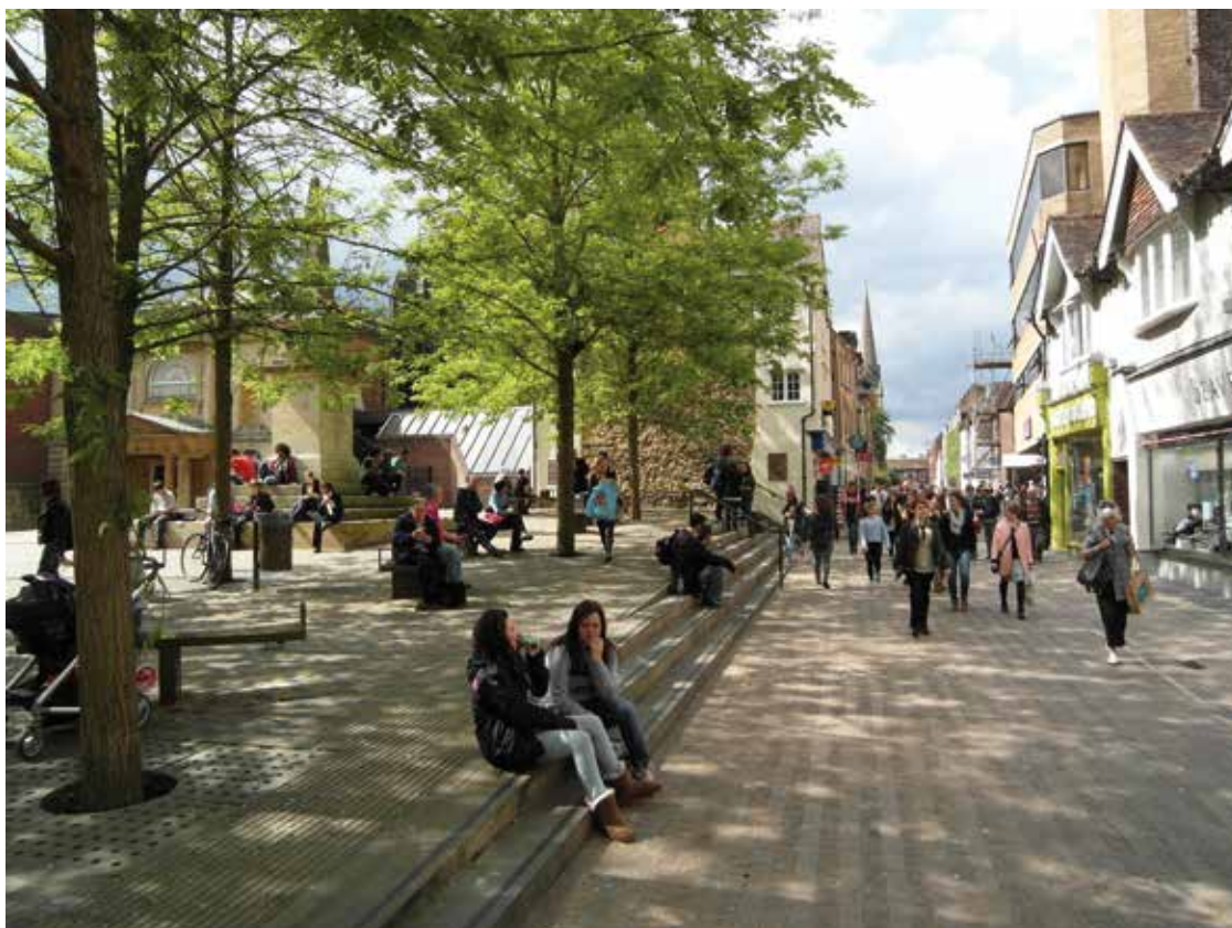
Sur Bonn Square à Oxford, le traitement des bordures de revêtements et des ouvertures de pied d'arbre a fait l'objet d'une attention particulière pour éviter tout conflit avec les racines. Image : Michael Murray
